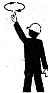
Heben des Kranhakens
