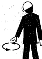
Senken des Kranhakens
